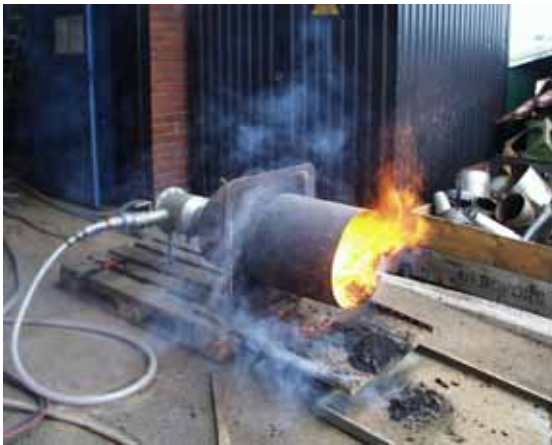
Figur 4 Pulverbrännare. Försöksbrännare 150 kW. Foto: Susanne Paulrud
